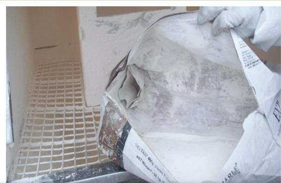
**5** Achten Sie auf die Fülltüle: wenn der Sack auf der Seite der Fülltüle aufgeschnitten wird, bleibt diese voll mit Produkt. Die Dunstabzugshaube sollte so bemessen sein, das aller Feinstaub aufgefangen wird.
