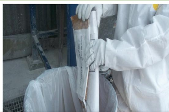
**7** Achten Sie darauf, dass der leere Sack sorgfältig gefaltet und in einem anderen Sack zur Entsorgung eingepackt ist. Verschließen Sie den Entsorgungssack sorgfältig zwischen den einzelnen Befüllungsvorgängen.
