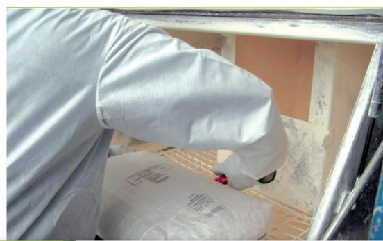
**2** Legen Sie den Sack so hin, dass die Fülltüle zum Anwender zeigt. Schneiden Sie den Sack auf der der Fülltüle gegenüberliegenden Seite auf
