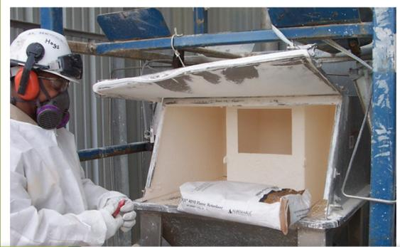
**1** Schalten Sie das Belüftungssystem ein. Legen Sie den Sack unter oder nahe an das Belüftungssystem, über den Entleerungsschacht.
